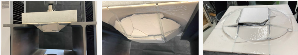
コンクリート押し抜きテスト 1 m 2 当り 3t の重さに耐えられます テスト後 (タイルは剥れても塗膜は破れない)
